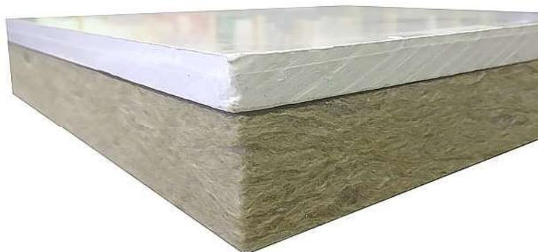
В качестве дополнительной звукоизоляции может применяться панель “Экстра”, которая дает дополнительную звукоизоляцию 5 дБ. Панель укладывается сверху на панели “Децибел”. Формат 1200x600x50мм с отделкой бесцветным стеклохолстом.
