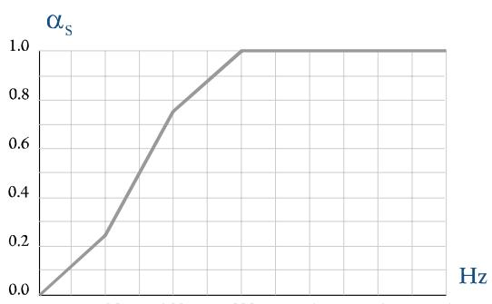
— ПАЛИТРА СХ Direct 40мм, вплотную к стене, α<sub>w</sub>=1.0
